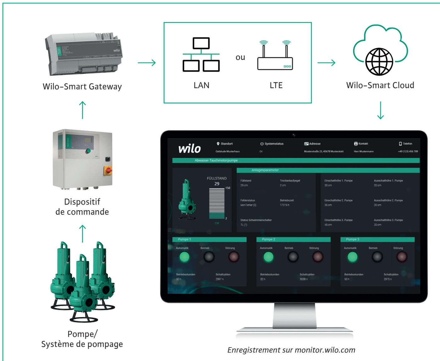
Nos techniciens de services Wilo équiperont votre pompe ou votre système de pompage avec la passerelle Wilo Smart-Gateway. Les données collectées sont ensuite transmises soit via Modbus RTU, Modbus TCP, soit via des contacts de signalisation existants, puis transmises à notre Cloud Wilo-Smart via LTE ou LAN.
