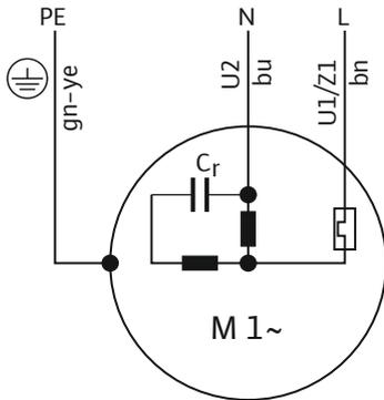
Fig. 7: Esquema de ligações do motor monofásico
