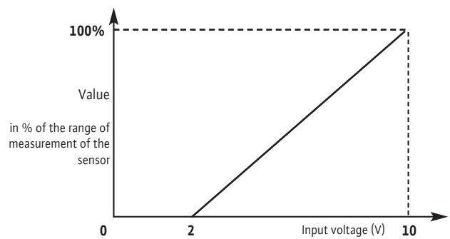
**IN2 : Input of the external set value control in « Constant pressure » and « P.I.D. control » mode**
