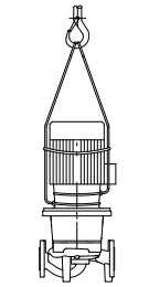
Fig. 29: Transport van de pomp
