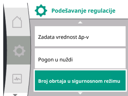
Fig. 79: Meni „Podešavanja regulacije sa pogonom u nuždi u slučaju otkaza senzora“
