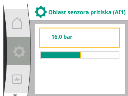
Fig. 77: Podešavanje oblasti senzora pritiska
