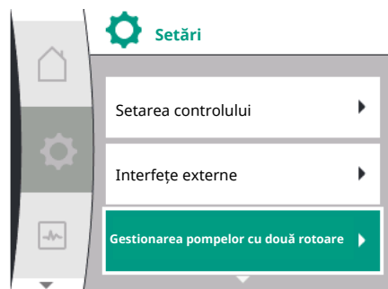
Fig. 54: Meniu gestionarea pompelor cu două rotoare
