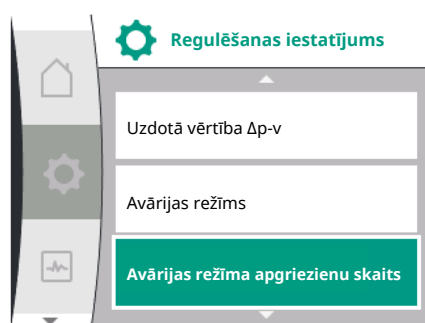
Fig. 50: Avārijas režīma apgriezīnu skaita iestatīšana
