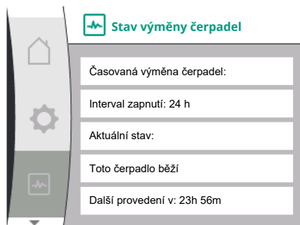
Fig. 104: Informace o stavu výměny čerpadla
