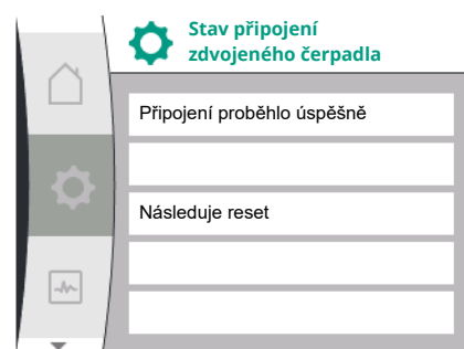
Fig. 57: Úspěšné připojení zdvojeného čerpadla
