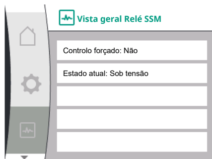
Fig. 100: Vista geral da função de relé SSM
