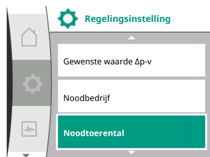
Fig. 79: Menu regelingsinstellingen met noodmodus bij uitval van de sensorwaarde
