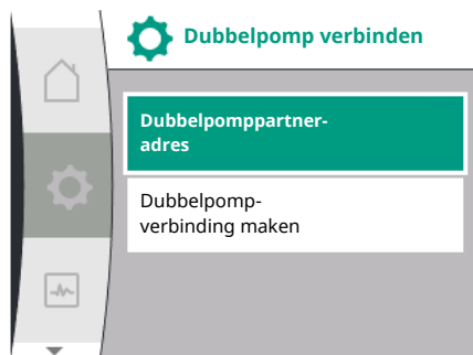
Fig. 56: Menu dubbelpomp verbinding tot stand brengen
