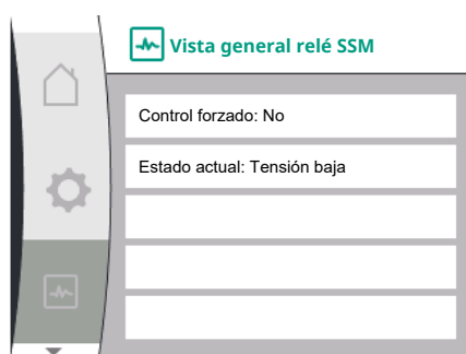
Fig. 100: Vista general de la función del relé SSM
