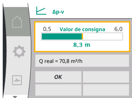
Fig. 38: Ajuste del valor de consigna en la pantalla de inicio \Delta p-v
