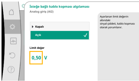
Fig. 83: Limit değeri kablo kopması
