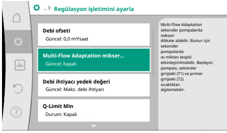
Fig. 64: Regülasyon işletimini ayarlama: Multi-Flow Adaptation mikser
