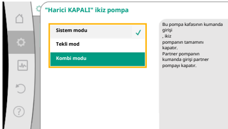
Fig. 70: İkiz pompalı EXT. OFF için seçilebilir modlar
