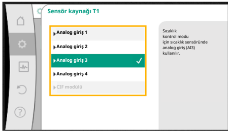
Fig. 51: Sensör kaynağının atanması
