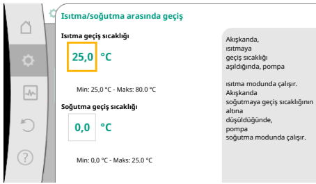
Fig. 56: Isıtma/soğutma_geçiş_sıcaklıkları arasında geçiş
