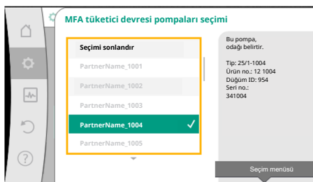
Fig. 63: Multi-Flow Adaptation için sekonder pompa seçimi
