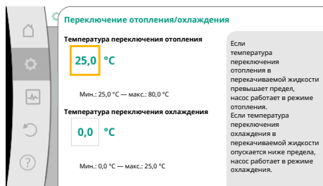
Fig. 56: Переключение отопления/охлаждения_Температуры переключения
