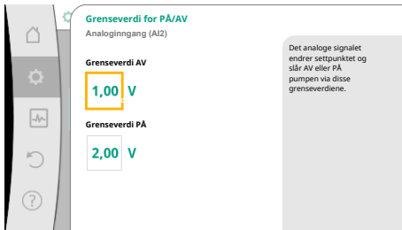
Fig. 85: Grenseverdier for AV/PÅ-styring via analogsignaler
