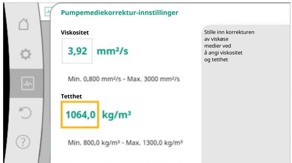
Fig. 102: Innstilling av viskositet og tetthet
