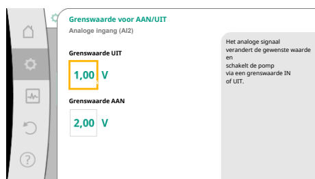
Fig. 85: Grenswaarden voor AAN/UIT-besturing via analoge signalen
