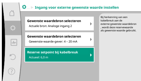
Fig. 88: Reserve setpoint bij kabelbreuk
