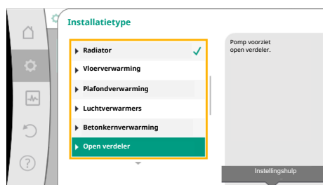
Fig. 59: Installatietype „Open verdeler”
