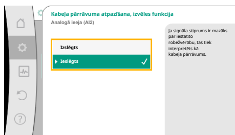
Fig. 82: Kabeļa pārrāvuma atpazīšana, izvēles funkcija
