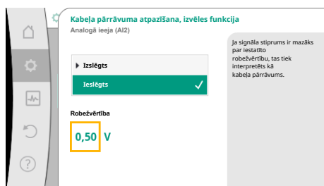
Fig. 83: Robežvērtība, kabeļa pārrāvums
