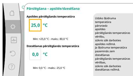
Fig. 56: Pārslēgšana – apsilde/dzesēšana_Pārslēgšanas temperatūra
