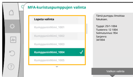
Fig. 63: Sekundaaripumppujen valinta Multi-Flow Adaptation –toimintoa varten
