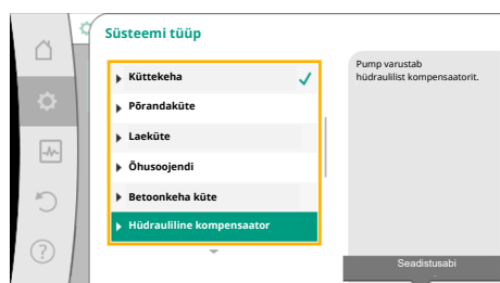
Fig. 59: Süsteemi tüüp „Hüdrauliline kompensaator“.
