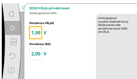
Fig. 85: SISSE/VÄLJA juhtimise piirväärtused analoogsignaali kaudu
