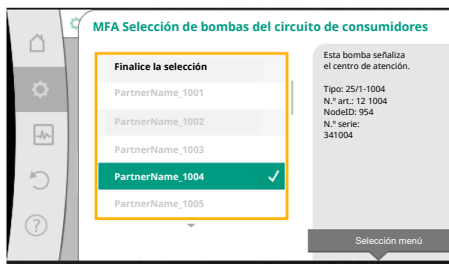
Fig. 63: Selección de las bombas secundarias para Multi-Flow Adaptation
