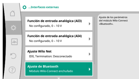
Fig. 93: Ajuste de la interfaz Bluetooth
