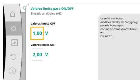
Fig. 85: Valores límite para conexión y desconexión a través de señal analógica
