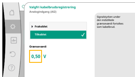
Fig. 83: Grænseværdi for kabelbrud
