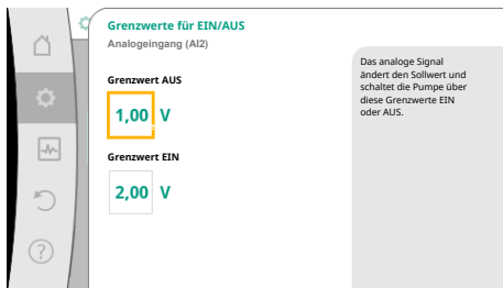
Fig. 85: Grenzwerte zur EIN/AUS-Steuerung über Analogsignale
