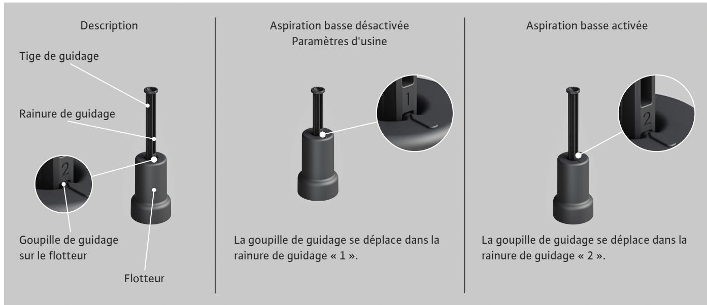
La rainure de guidage dans la tige de guidage guide le flotteur. Lorsque le point de commutation est atteint, la tige de guidage appuie sur le contact de commutation. La pompe se met en marche. Lorsque le niveau d'eau baisse, le flotteur descend. La tige de guidage se détache du contact de commutation, la pompe s'arrête.
