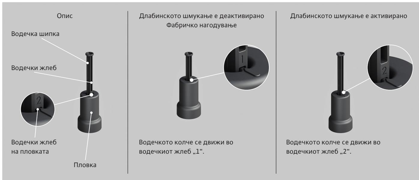
Водечкиот жлеб во водечката шипка ја води пловката. Кога ќе се достигне точката на вклучување, водечката шипка го притиска прекинувачот. Пумпата се вклучува. Кога нивото на водата ќе се намали, пловката се движи надолу. Водечката шипка се одделува од контактот на прекинувачот и пумпата се исклучува.
