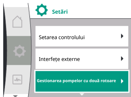
Fig. 48: Meniu gestionarea pompelor cu două rotoare
