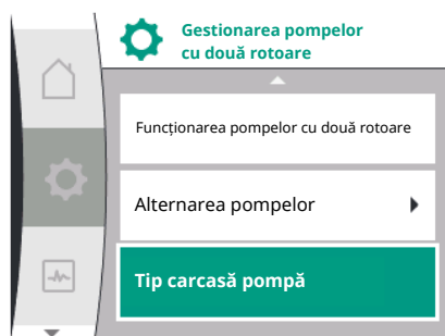
Fig. 55: Meniu gestionarea pompelor cu două rotoare
