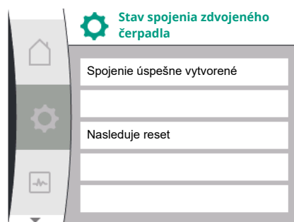
Fig. 51: Úspešne vytvorené spojenie zdvojeného čerpadla
