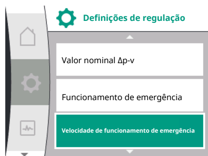
Fig. 44: Regulação da velocidade de funcionamento de emergência
