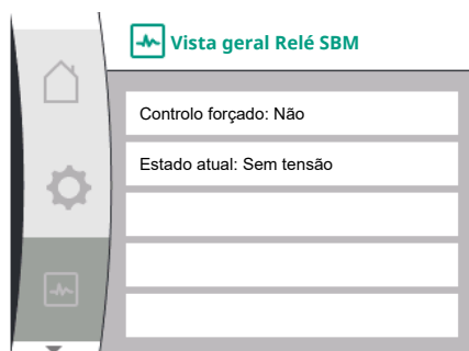
Fig. 95: Vista geral da função de relé SBM
