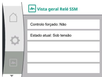
Fig. 94: Vista geral da função de relé SSM
