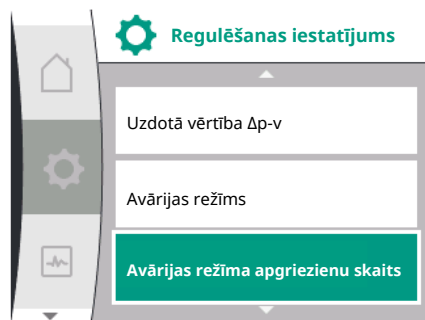
Fig. 73: Regulēšanas iestatījumu ar avārijas režīmu izvēle sensora vērtības atteices gadījumā
