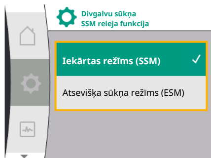
Fig. 61: Divgalvu sūkņa SSM releja funkcijas izvēlne
