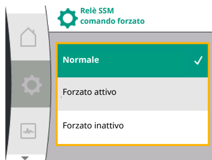
Fig. 62: Comando forzato relè SSM
