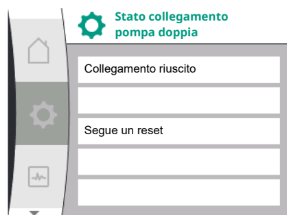
Fig. 51: Collegamento di pompa doppia riuscito
