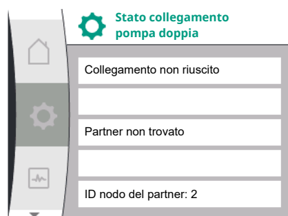
Fig. 52: Collegamento doppio fallito
