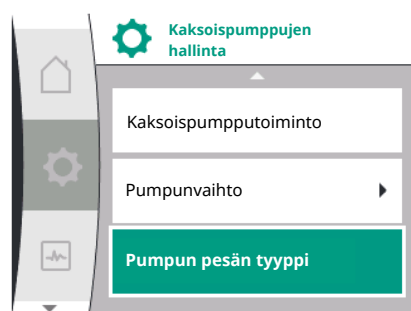
Fig. 55: Valikko Kaksoispumppujen hallinta
