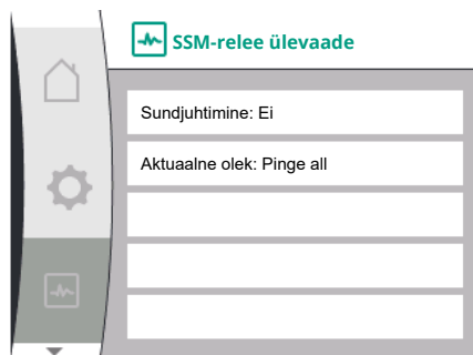
Fig. 94: Releefunktsiooni SSM ülevaade
