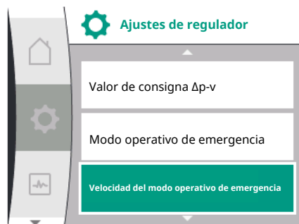
Fig. 44: Ajuste de la velocidad del modo operativo de emergencia
