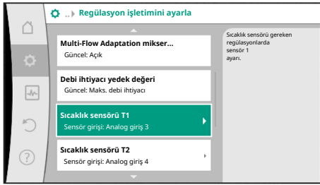
Fig. 62: Multi-Flow Adaptation mikser: Sıcaklık sensörü
