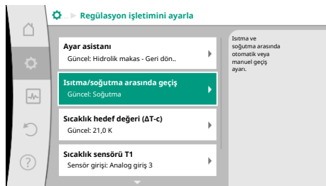
Fig. 48: Isıtma/soğutma arasında geçiş
