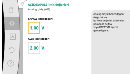
Fig. 81: Analog sinyaller üzerinden AÇIK/KAPALI kumandası ile ilgili limit değerleri
