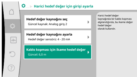
Fig. 84: Kablo kopması için ikame hedef değer
