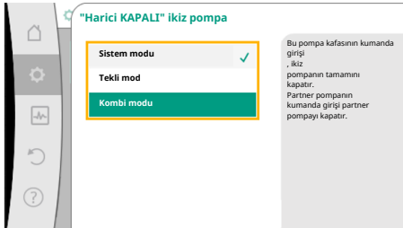
Fig. 66: İkiz pompalı EXT. OFF için seçilebilir modlar
