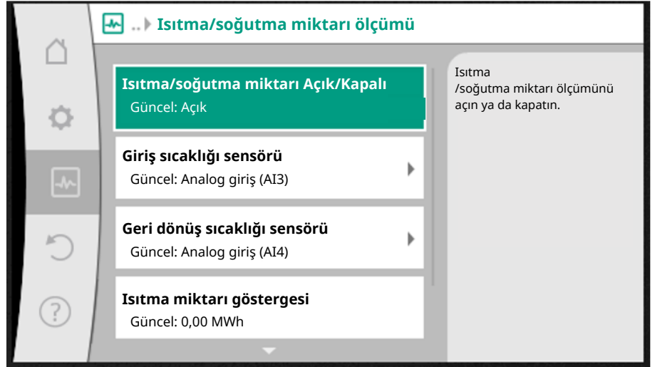
Fig. 93: Isıtma/soğutma miktarı algılama
