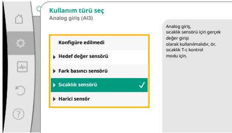
Fig. 85: Gerçek değer sensörü ayar iletişim kutusu
