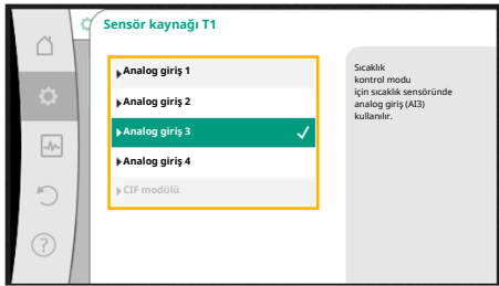
Fig. 47: Sensör kaynağının atanması
