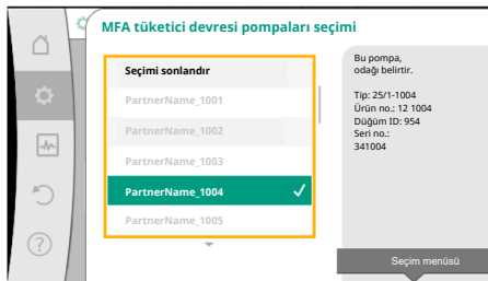
Fig. 59: Multi-Flow Adaptation için sekonder pompa seçimi
