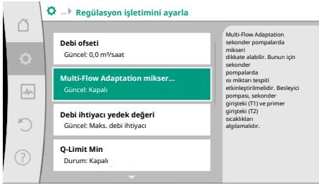
Fig. 60: Regülasyon işletimini ayarlama: Multi-Flow Adaptation mikser
