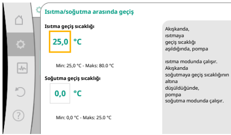
Fig. 52: Isıtma/soğutma_geçiş_sıcaklıkları arasında geçiş
