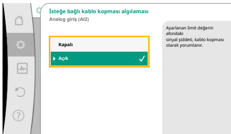
Fig. 78: İsteğe bağlı kablo kopması algılaması
