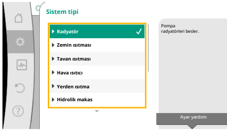
Fig. 42: Örnek "Radyatör" sistem tipi
