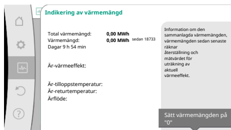
Fig. 94: Indikering av värmemängd
