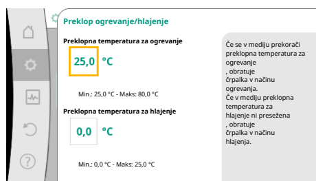
Fig. 52: Preklop ogrevanje/hlajenje_preklopne temperature
