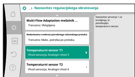
Fig. 62: Multi-Flow Adaptation mešalnik: Temperaturni senzorji
