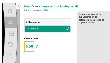
Fig. 79: Valoare limită cablu rupt
