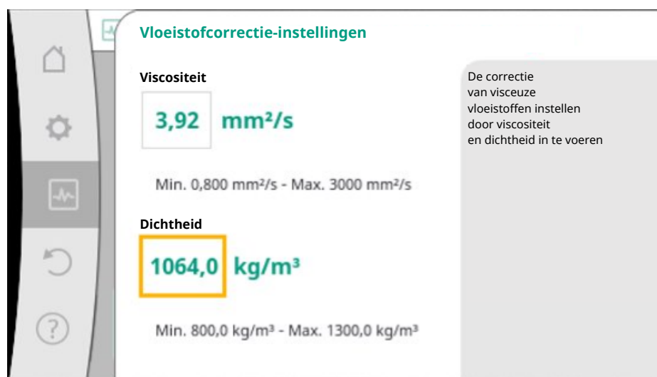
Fig. 98: Instelling van viscositeit en dichtheid
