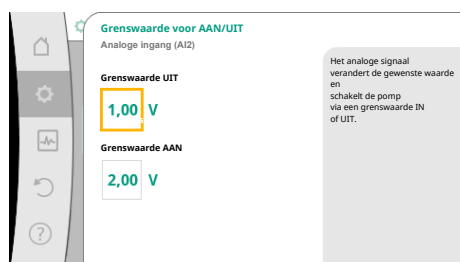
Fig. 81: Grenswaarden voor AAN/UIT-besturing via analoge signalen
