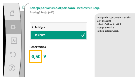
Fig. 79: Robežvērtība, kabeļa pārrāvums
