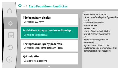
Fig. 60: Szabályozóüzem beállítása: Multi-Flow Adaptation keverőselelep
