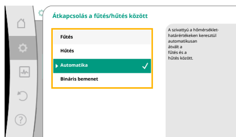
Fig. 51: Átkapcsolás a fűtés/hűtés között_Automatika
