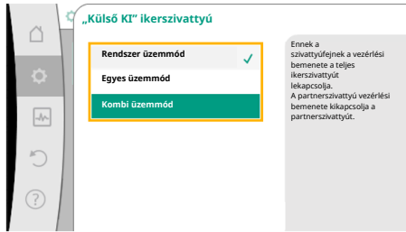
Fig. 66: Választható üzemmódok EXT. OFF esetén ikerszivattyúkhöz
