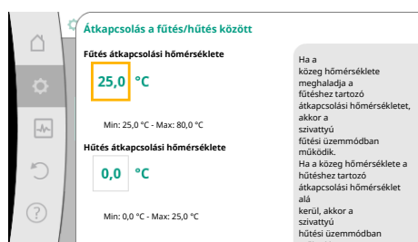
Fig. 52: Átkapcsolás a fűtés/hűtés között_Átkapcsolási hőmérsékletek
