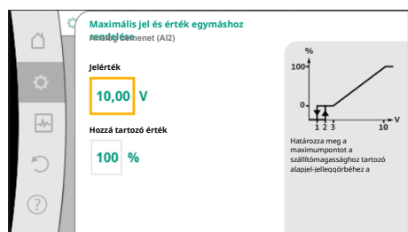
Fig. 83: Maximális jel és érték egymáshoz rendelése
