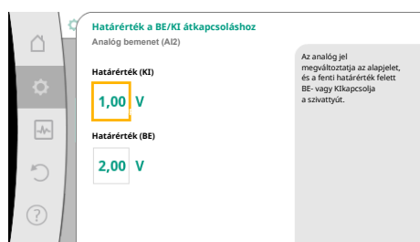
Fig. 81: Az analóg jelekkel végzett BE/KI vezérlés határértékei
