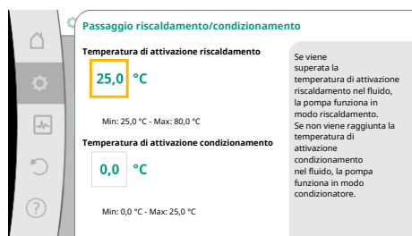
Fig. 52: Passaggio riscaldamento/condizionamento_Temperature di commutazione
