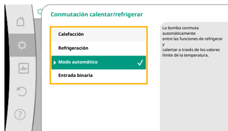
Fig. 51: Conmutación calefacción/refrigeración_Modo automático
