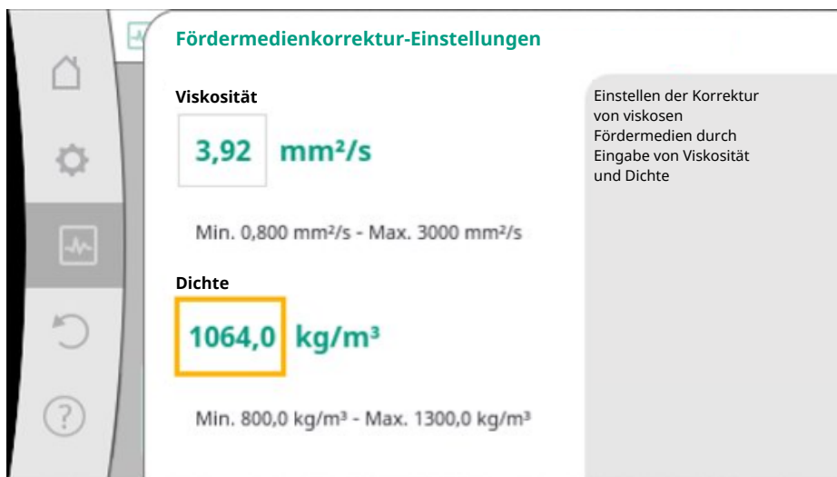
Fig. 98: Einstellung von Viskosität und Dichte
