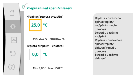
Fig. 52: Přepínání vytápění/chlazení_teploty přepnutí
