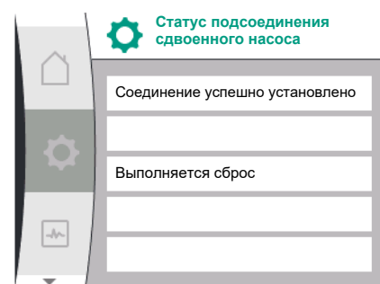
Fig. 51: Успешное подсоединение сдвоенного насоса
