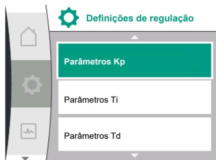
Fig. 41: Regulação de parâmetros PID
