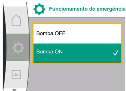
Fig. 43: Regulação do funcionamento de emergência
