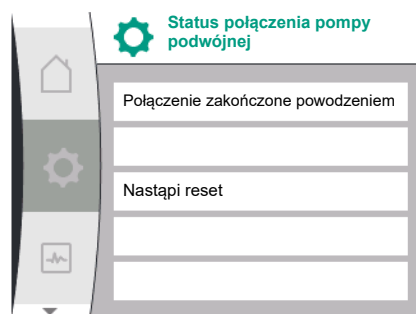
Fig. 51: Połączenie pompy podwójnej zakończone powodzeniem
