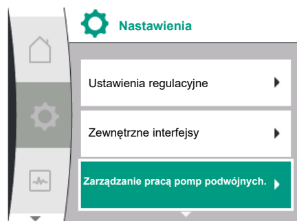
Fig. 48: Menu Zarządzanie pracą pomp podwójnych
