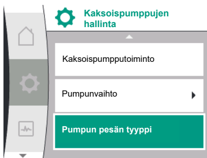
Fig. 55: Valikko Kaksoispumppujen hallinta
