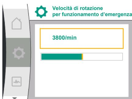
Fig. 45: Velocità di rotazione per funzionamento d'emergenza
