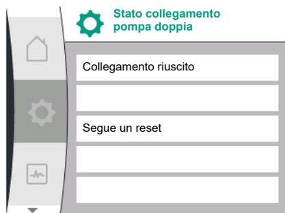
Fig. 51: Collegamento di pompa doppia riuscito
