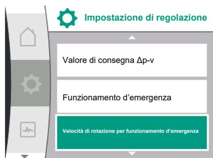
Fig. 44: Impostazione velocità di rotazione per funzionamento d'emergenza
