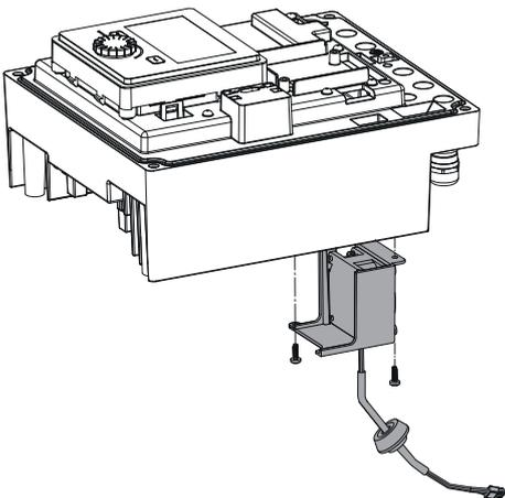
Fig. 108: Modullüfter inkl. Kabel und Gummidichtung abnehmen
