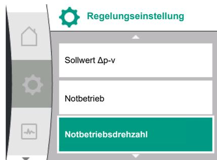
Fig. 73: Menü Regelungseinstellungen mit Notbetriebsmodus bei Ausfall des Sensorwerts
