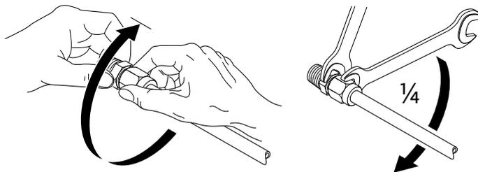
Fig. 13: Weiterdrehen der Klemmringverschraubung um 1/4 Umdrehung
