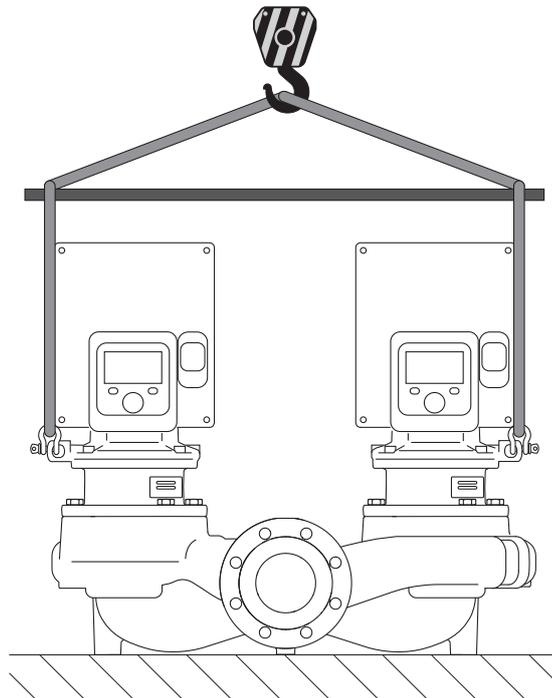
Fig. 7: Heberichtung Doppelpumpe
