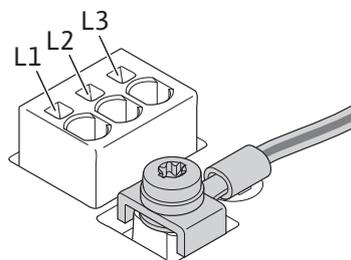
Netzklammer für 1~ Netzanschluss mit Erdung
