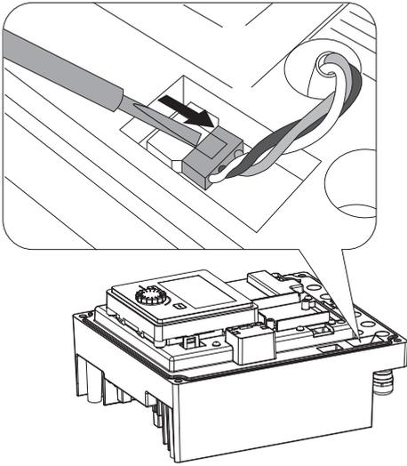
Fig. 106: Anschlusskabel des Modullüfters lösen
