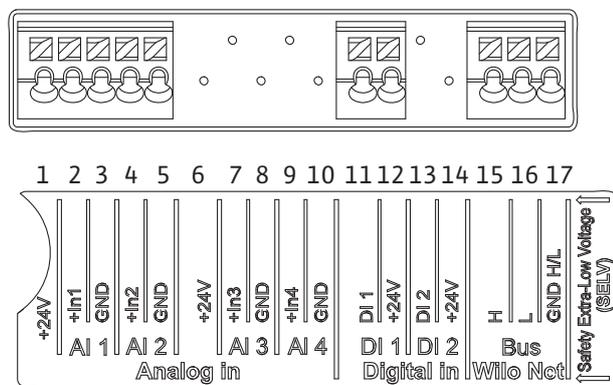
Fig. 21: Klemmen für Analogeingänge, Digitaleingänge und Wilo Net
