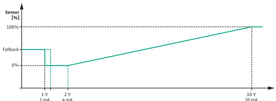
Fig. 72: Verhalten Analogeingang AI 1: Sensorwert bei Signaltyp 2 ... 10 V / 4 ... 20
