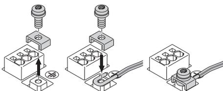
Fig. 23: Starres Anschlusskabel
