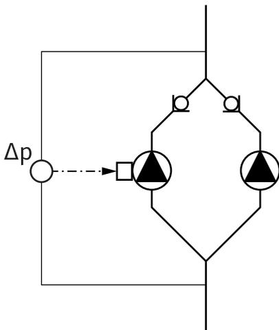
Fig. 18: Beispiel – Anschluss Differenzdruckgeber in Hosenrohrinstallation
