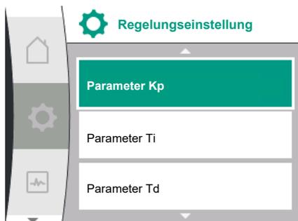
Fig. 41: Einstellung PID-Parameter
