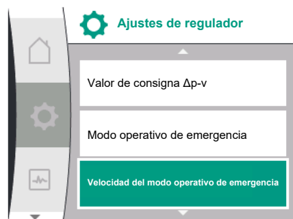
Fig. 73: Menú Ajustes de regulador con modo operativo de emergencia en caso de avería del valor del sensor
