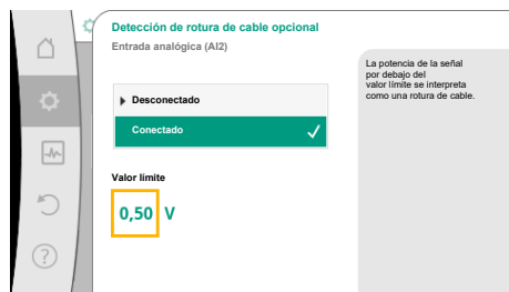
Fig. 78: Valor límite de rotura de cable
