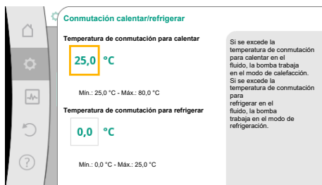
Fig. 51: Conmutación calefacción/refrigeración_Temperaturas de conmutación
