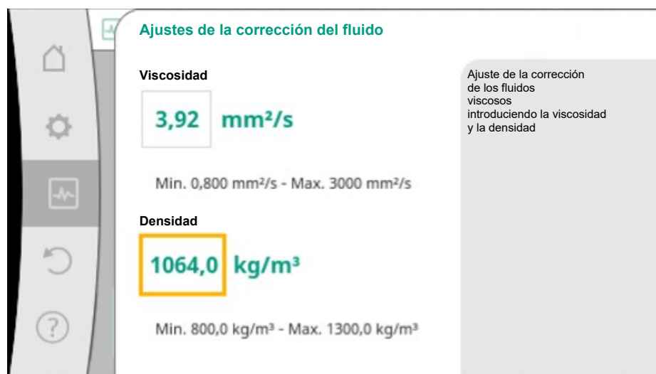
Fig. 97: Ajuste de viscosidad y densidad
